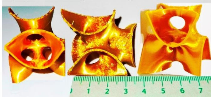
Рисунок 5 – Друковані елементи за алгоритмом ADMS на 3D-принтері методом FDM
