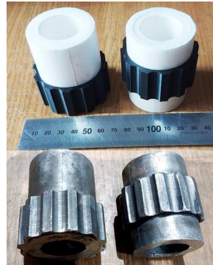
Рисунок 4 - Моделювання у програмі Rhinoceros 8 за алгоритмом ADMS: а – заповнення оболонками простору «куб» з каналом під трубу профільну квадратну; б – модель шестерні; в – модель «втулка приводна»; г – ливарні моделі і виливки «втулка приводна» (3D-друк суцільної моделі зі вставкою з ППС)
